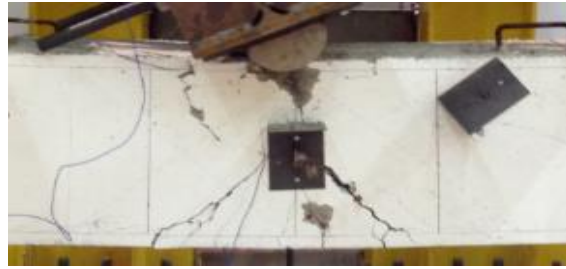
Şekil 8. Deney 3 numunesi hasar durumu
