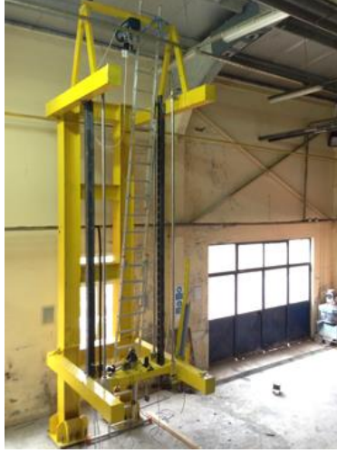
Şekil 2. Çarpma testi deney düzeneği
