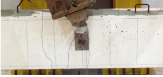
Şekil 6. Deney 1 numunesi hasar durumu
